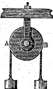
(obr. 47.) položený závaží, neotáčí se tato čili je v rovnováze, když jsou na obou koncích závaží stejná. Kladka
