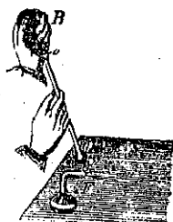
Kterak na rource koule se vyfukuje.
